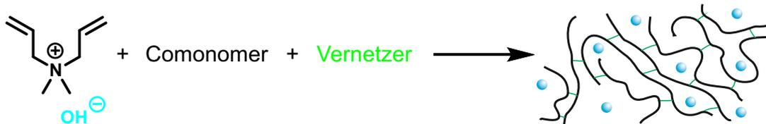
Stahlbeton ist das am häufigsten eingesetzte Baumaterial. Das Eindringen von atmosphärischem  $\text{CO}_2$  und Chloriden aus Tausalzen und Meerwasser kann die strukturelle Integrität gefährden. Die notwendigen Instandsetzungsmaßnahmen verursachen einen hohen volkswirtschaftlichen Schaden. In ersten Versuchen konnte gezeigt werden, dass diese Gele eine günstige und nachhaltige Alternative bieten.
